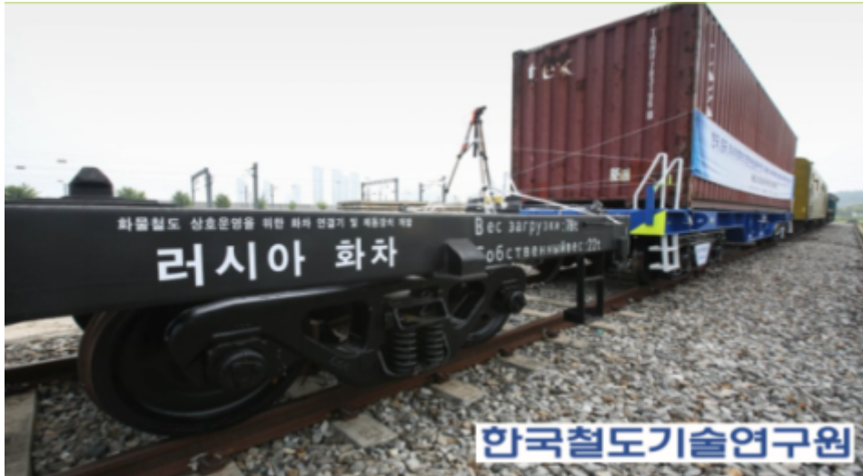
[그림 1] 궤간가변화차와 러시아 화차 주행시험
